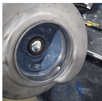
Aplicación de primera capa de Belzona 1321
