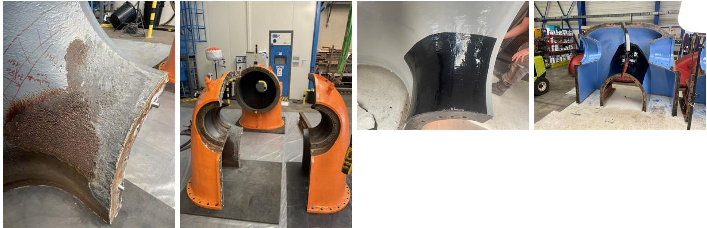
Dommages causés par l'érosion et la cavitation conduisant à une perte de d'épaisseur supérieure à 5 mm.
