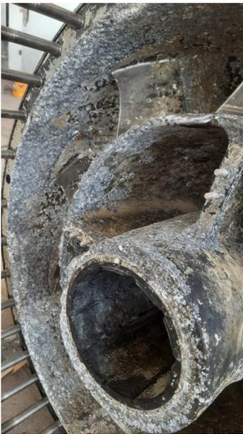
BEFORE SURFACE PREPARATION SHOWING THE EXTENT OF DAMAGE DUE TO METALLIC EROSION.
