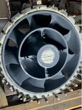
BEFORE SURFACE PREPARATION SHOWING THE EXTENT OF DAMAGE DUE TO METALLIC EROSION.
