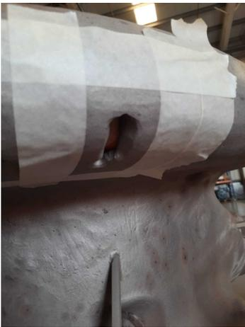
WIDENED CRACK LINE DRILLED ON BOTH ENDS.
