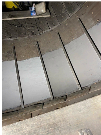
Defekte Oberfläche aufgebaut mit Belzona 4111 (Magma-Quartz).
