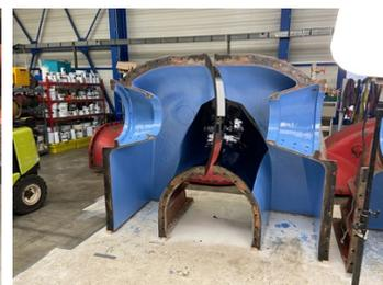
Domages causés par l'érosion et la cavitation conduisant à une perte de d'épaisseur supérieure à 5 mm.
